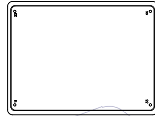
No. 2 盖上盒盖并在四周订上订书钉 真空盒盖规格:SB-24B0 (369*280*18mm)
